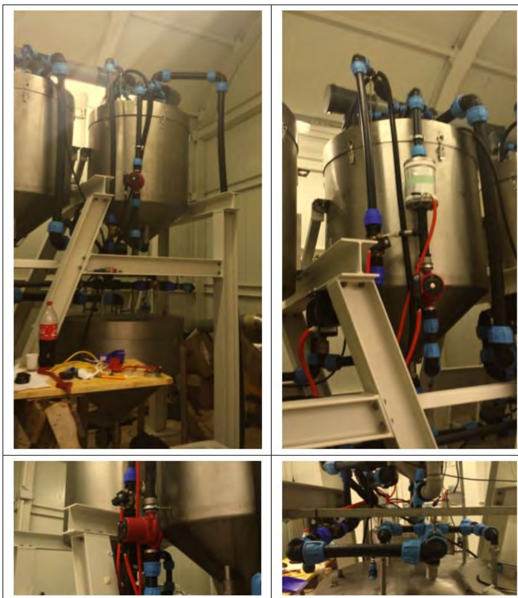
Slika 5.2 Detalji izvedbe uređaja za pročišćavanje procjednih voda.
