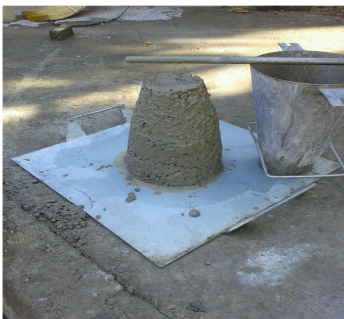
Slika 34 Kalup za mjerenje konzistencije betona i uzorak
