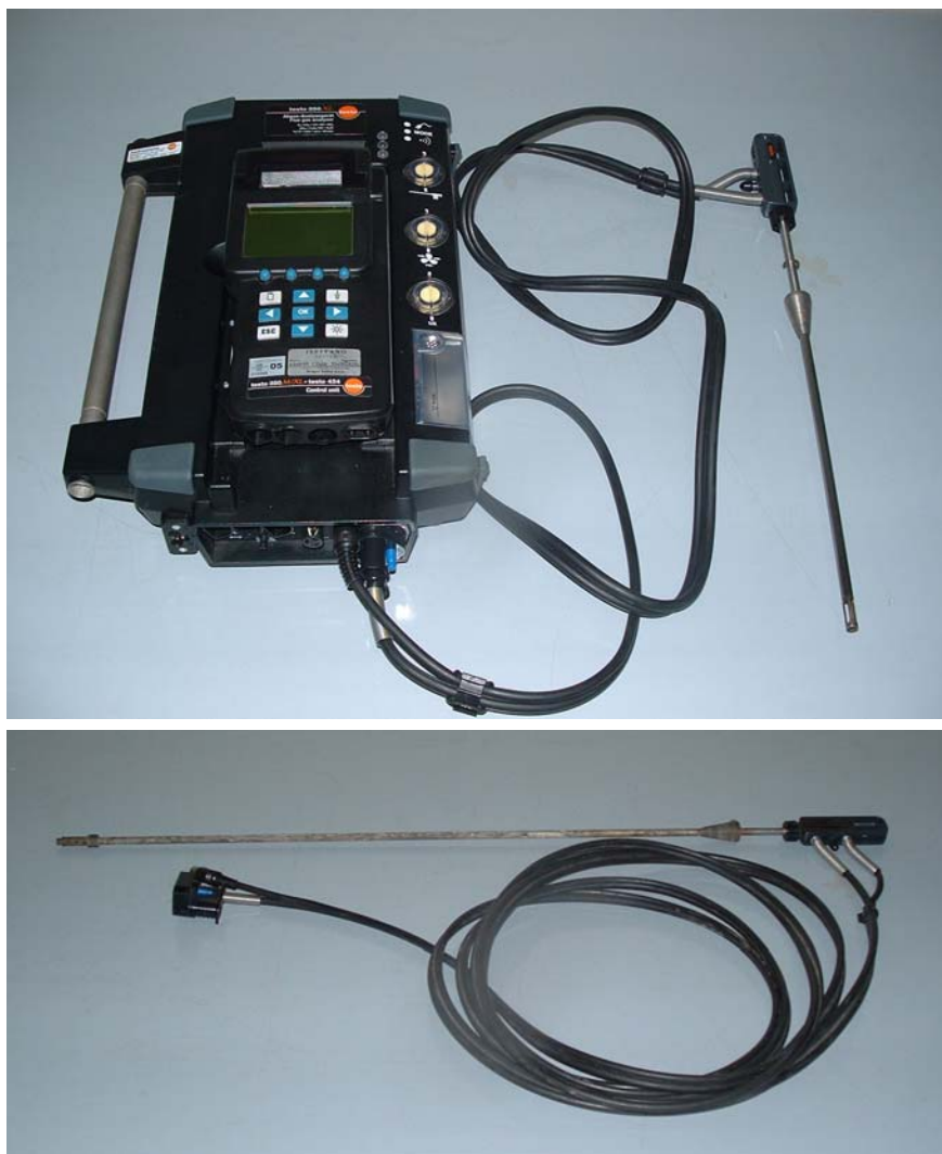
Sl. 25.2 Mjerni uređaj Testo 350/400 s mjernim sondama za dimne plinove
